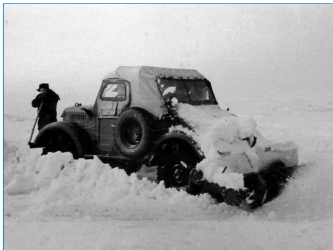
ГАЗ-69 на укатке ледового аэродрома. В таком же качестве эти машины использовались на дрейфующих станциях в Арктике
