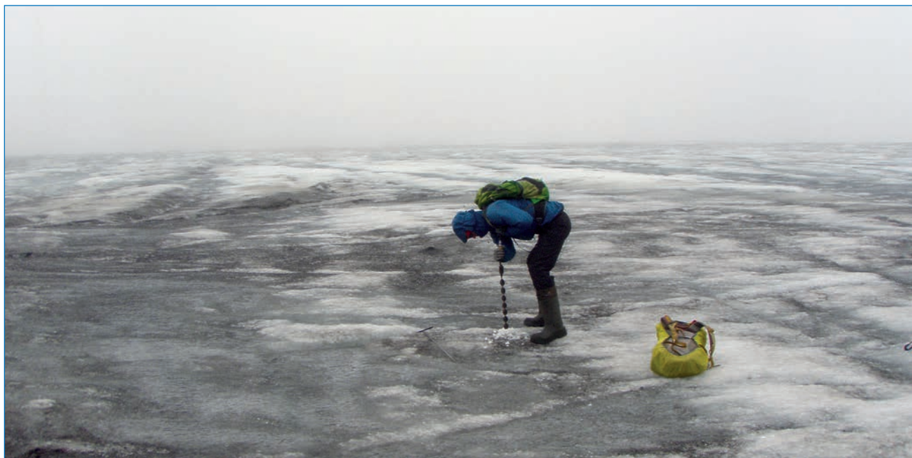
Бурение скважины во льду для абляционной рейки
