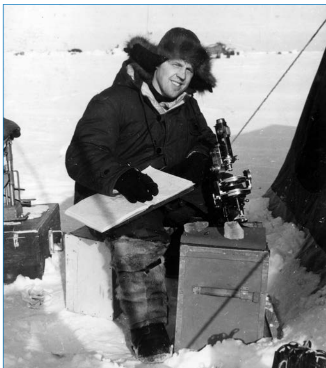
Изучение шлифов льда при помощи поляризационного микроскопа. Экспедиция «Север», середина 1950-х годов. Фонды ААНИИ
