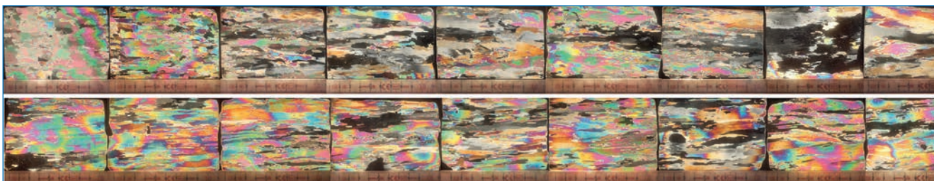
Рис. 6. Структура ровного льда, извлеченного 29 мая 2023 года
