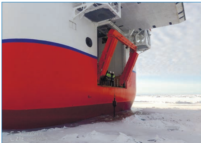
Работа с тяжелым геологическим оборудованием (донной трубкой) с кормы НЭС «Северный полюс». 18 сентября 2023 года. Фото А.С. Грубого
