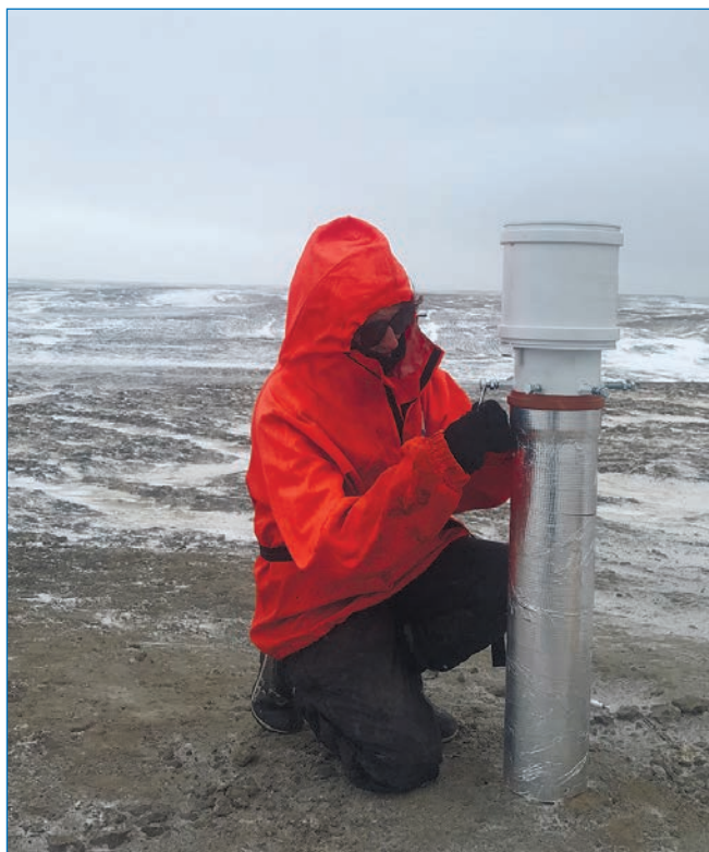
А.В. Гузева завершает установку термокосы со спутниковым передатчиком в скважине на о. Визе
