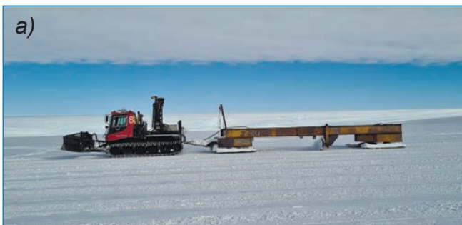
Выравнивание (а) и фрезеровка (б) поверхности ПП «Зенит»
