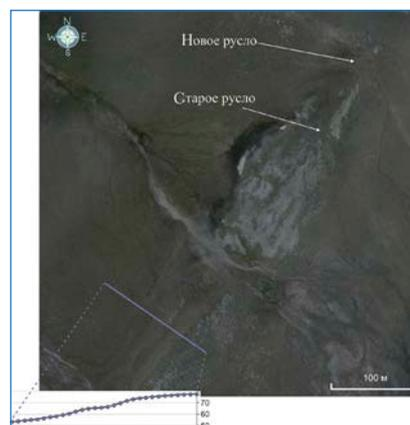
6 м и его приподнятость относительно современного на 0,7 м. Смещение носит левосдвиговой характер. На приразломном уступе выделяются четкие ступени высотой в 10 и 12 м, вследствие чего можно сделать вывод о неравномерном подрастании уступа в несколько этапов. В пределах разломной зоны также отмечаются современные процессы разжижения и оползания грунтов.
