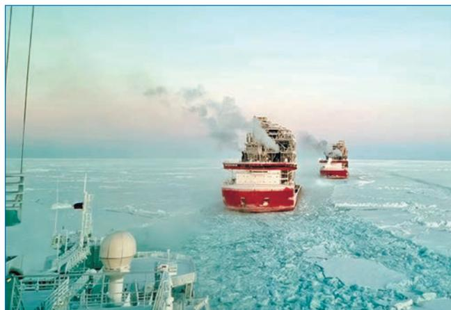
Проводка модулевозов в условиях сжатия льда
