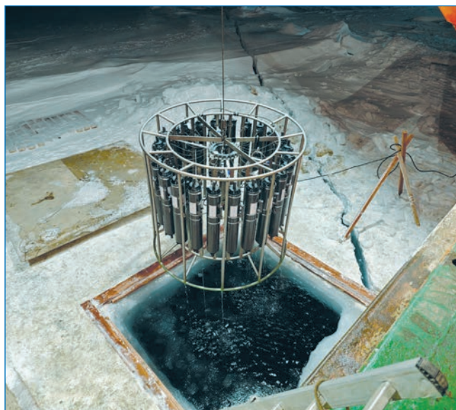
Майна у кормы НЭС «Северный полюс». Отбор проб воды с разных глубин при помощи розетты. 11 декабря 2024 года
