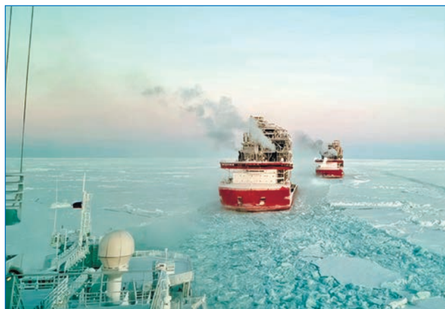
Проводка модулевозов в условиях сжатия льда
