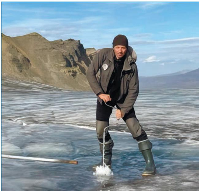
Рис. 2. Процесс установки абляционных реек на леднике Западный Грөнфьорд.
