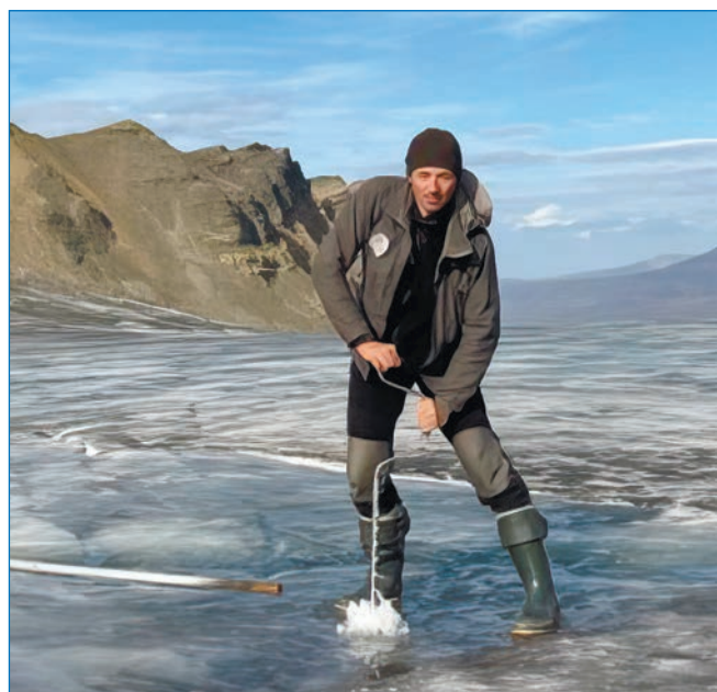
Рис. 2. Процесс установки абляционных реек на леднике Западный Грёнфьорд. Фото А.В. Терехова
