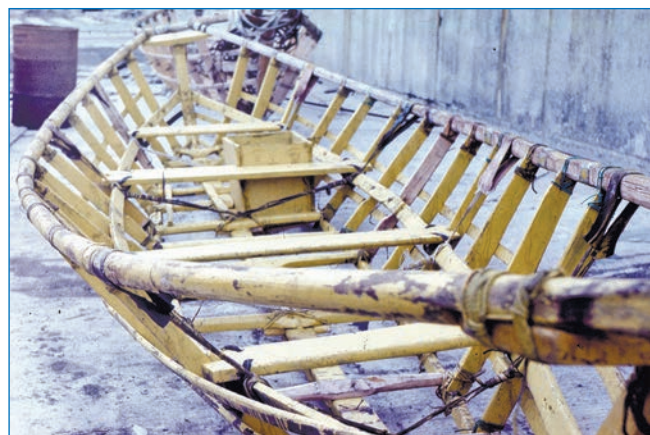
Каркас байдары. Все крепления из кожаных ремешков
