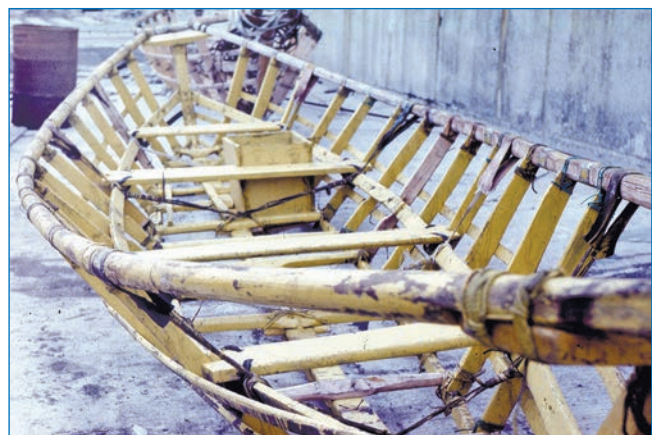
Каркас байдары. Все крепления из кожаных ремешков
