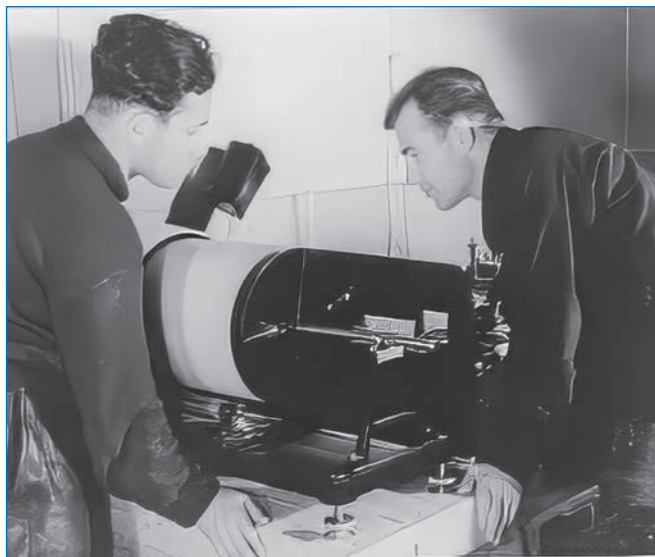
Сейсмологи А.М. Поликарпов и А.Д. Сытинский за регулировкой прибор- регистраторов сейсмостанции в Мирном. 1956 год. Фонды ААНИИ
