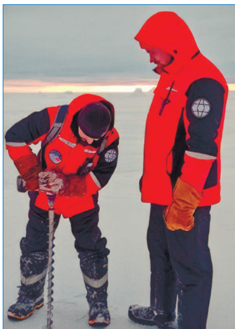
Рис. 7. Измерения толщины льда (слева) и постановка буя-маркера (справа) в ходе обследования ледяных полей при выполнении воздушной разведки 11 сентября
