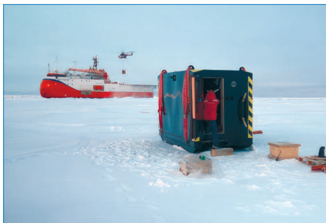
Рис. 9. Работы вертолета с подвеской по выгрузке крупногабаритных элементов инфраструктуры ледового лагеря
