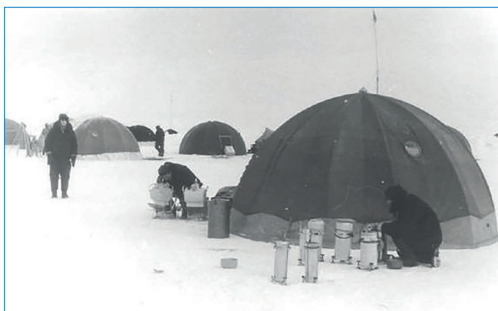
Рис. 4. Наблюдения на гравиметрах перед вылетом в рейс на дрейфующем опорном пункте ВВШЭ «Север-14», 1962 год. На переднем плане — съемочные гравиметры, слева — два стационарных гравиметра, в палатке — маятниковый прибор ММП-П. Фонды ААНИИ
