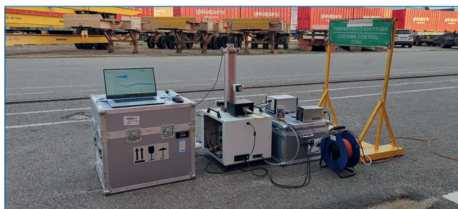
Рис. 10. Транспортный ящик, ПК, гравиметр и сервисное оборудование на причале «Петролеспорта» (Санкт-Петербург). Август 2024 года. Фото Д.К. Дронова
