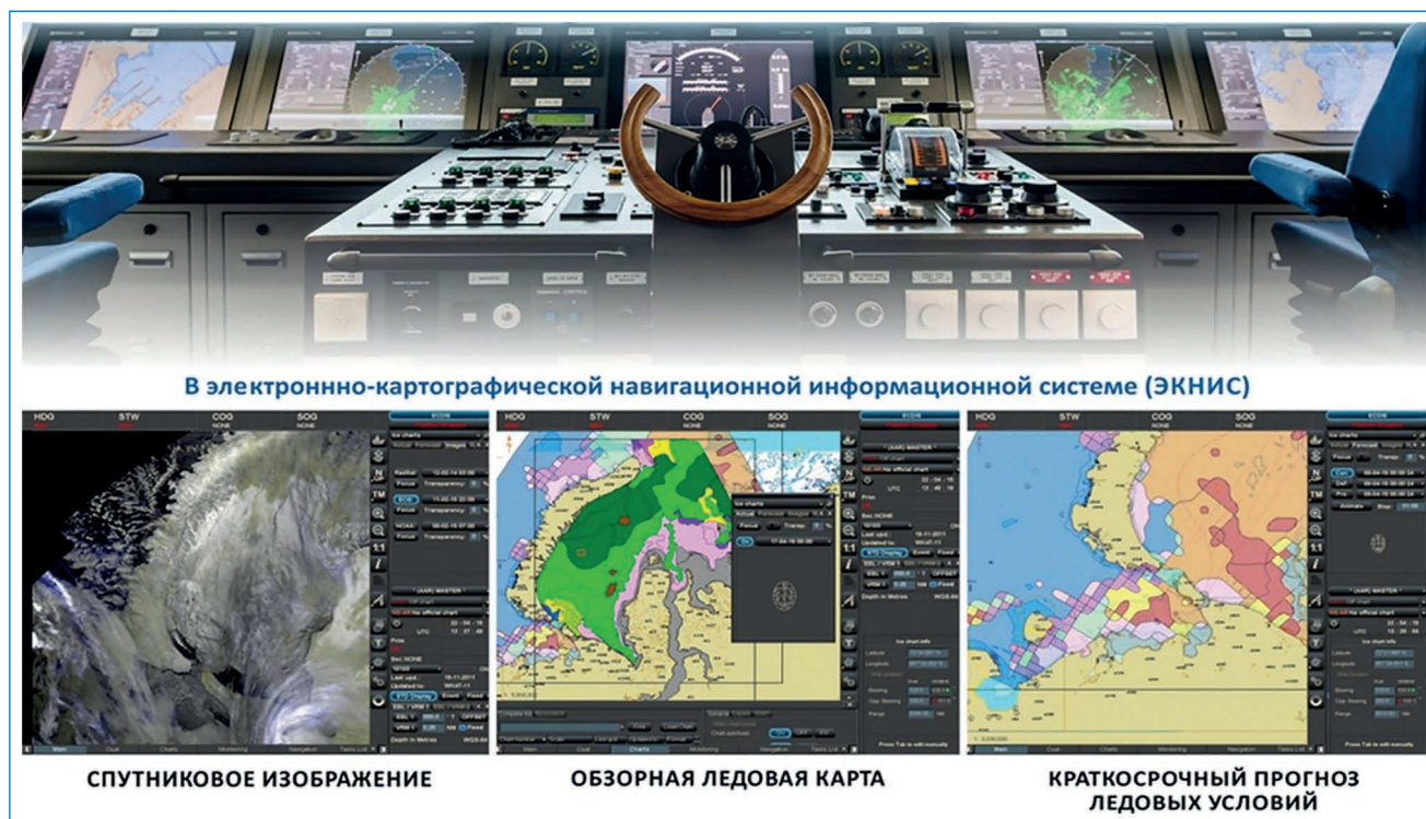
Совмещение навигационной карты, спутникового снимка и рекомендованного маршрута в ЭКНИС
