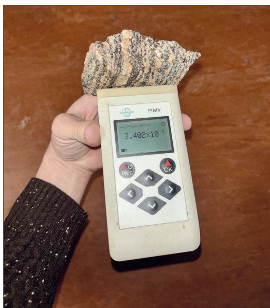
Процесс измерения магнитной восприимчивости
