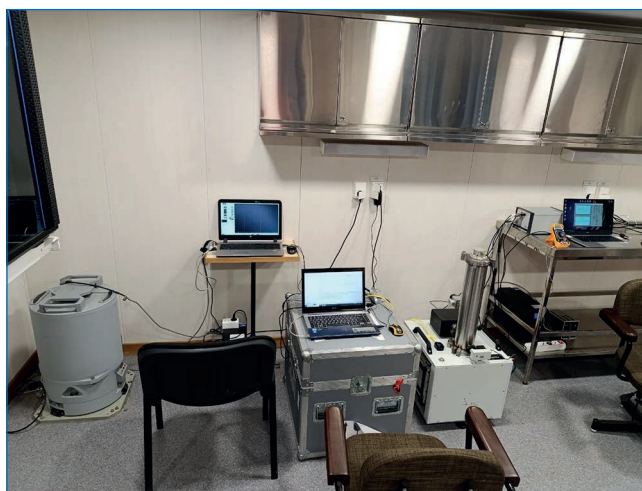
Рис. 11. Абсолютный гравиметр ГАБЛ-ПМ в лаборатории специальных исследований на борту НЭС «Северный полюс». Август 2024 года. Фото Д.К. Дронова
