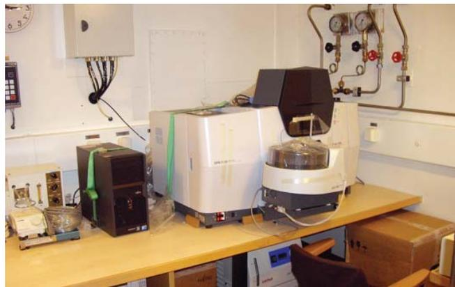
Солемер Autosal 8400 (слева), атомноабсорбционный спектрометр AA-7000 (справа).
