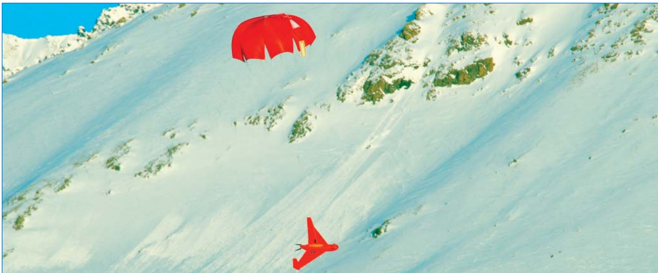
БЛА «Элерон-10Э» в процессе приземления. Фото К.С.Йохансена (NORUT)
