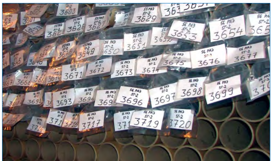
Рис. 2. Новый керн, полученный в сезонный период 56-й РАЭ в кернохранилище 5Г на станции Восток. Фото В.Я.Липенкова
