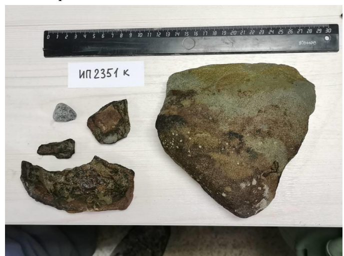
Рисунок 12.6 – Донный каменный материал (ДКМ) с некоторых станций донного опробования, полученный в 2023 г.: слева - станция ИП-2310К, железо-марганцевые корки, справа – станция ИП-2351К, мезозойские песчаники
