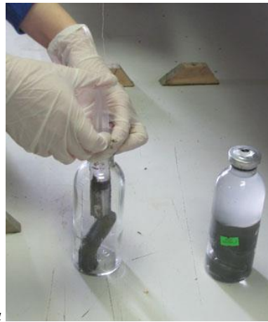
Рисунок 12.5 – Перенос образца донного осадка в стеклянный флакон (а) и укупорка флакона (б) для подготовки проб газа методом хэд-спейс
