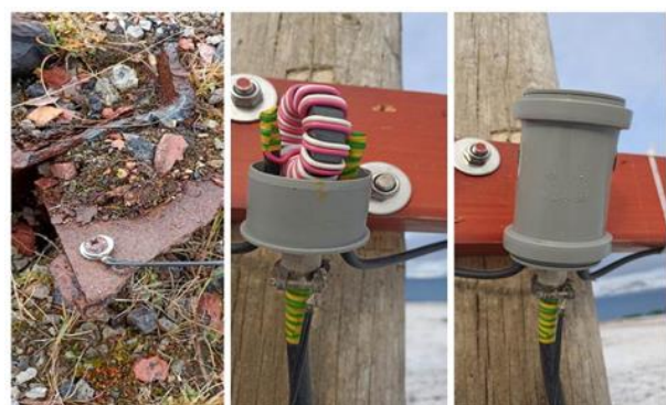
Рисунок 17.13 – Точка подключения заземления антенны риометрического приемника, согласующее устройство («балун») в разобранном и собранном виде
