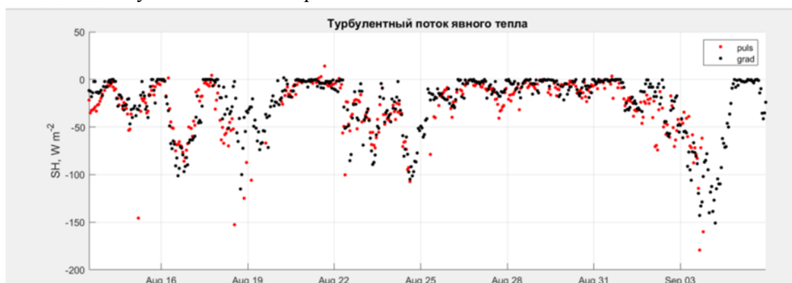
Рисунок 19.2 – Сравнение данных измерений и расчетов потока явного тепла на леднике Альдегонда
