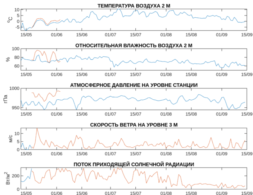
Рисунок 1.13 – Сезонный ход метеорологических параметров по данным АМС в 2023 г. красная линия – верхняя АМС, синяя линия – нижняя АМС
