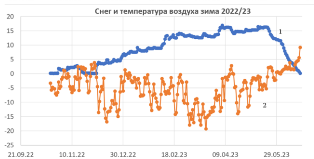
Рисунок 13.2 – Толщина снега на метеостанции, дм – 1 и температура воздуха, °С – 2
