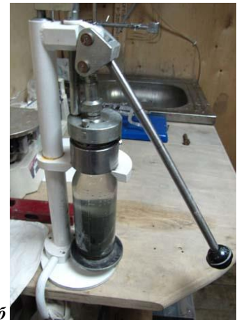
Рисунок 12.5 – Перенос образца донного осадка в стеклянный флакон (а) и укупорка флакона (б) для подготовки проб газа методом хэд-спейс
