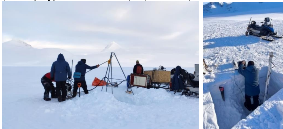
Рисунок 4.6 – Термобуровые работы на скважине №2 на леднике Альдегонда и установка термокосы
