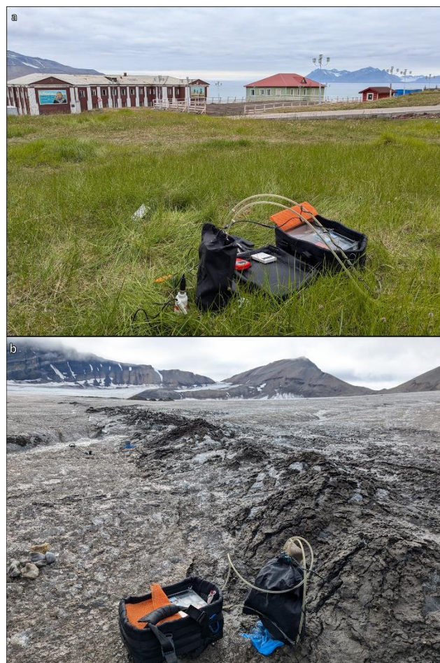
Рисунок 13.5 – Полевые измерения эмиссии диоксида углерода с использованием модифицированного газоанализатора AZ-77535 (режим «темной» камеры), влагомера SM-150 Delta-T и термометра Checktemp-1 Delta-T: a – ключевой участок «Бассейн», антропогенно-изменённая экосистема объекта городской зеленой инфраструктуры селитебной зоны п. Баренцбург; b – ключевой участок «Ледник Альдегонда», скопление мелкодисперсного суглинистого криоконитового материала на поверхности ледника
