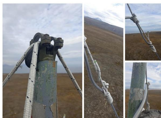
Рисунок 17.11 – Состояние узлов крепления магнитных рамочных антенн на вершине мачты
