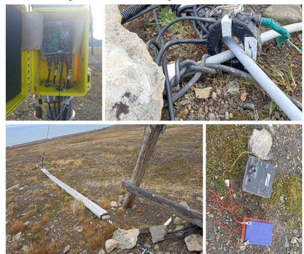
Рисунок 17.13 – Подключение калибровочного устройства к входу антенны, установка калибровочного тороида и калибровочное устройство, запитанное от аккумулятора
