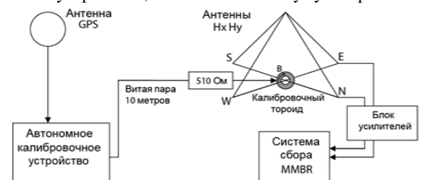
Рисунок 17.14 – Схема калибровки магнитных рамочных антенн тороидальной катушкой
