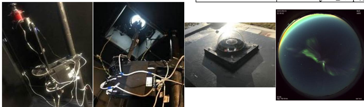
Рисунок 16.11 – слева направо: общий вид КВН, КВН под блистером, вид на блистер КВН, кадр КВН
