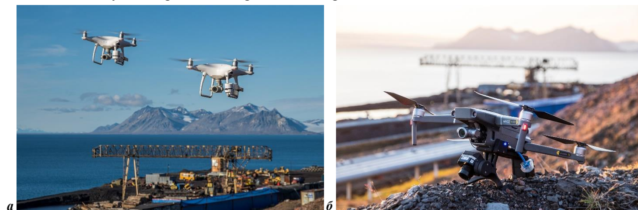
Рисунок 20.1 – Оборудование, использованное для измерений на архипелаге Шпицберген: два квадрокоптера DJI Phantom 4 Pro с датчиками iMet-XQ2 (а) и квадрокоптер DJI Mavic 2 Zoom с тепловизором Flir TAU 2R (б)
