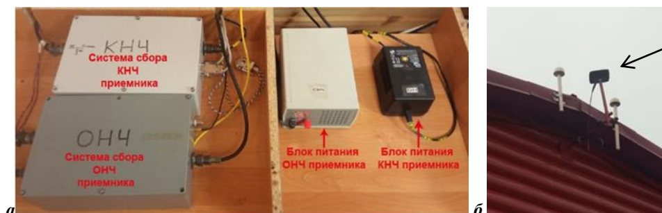
Рисунок 18.5 – Системы сбора приемников ОНЧ и КНЧ и их блоки питания(а) и GPS/ГЛОНАСС антенна ОНЧ приемника (б)
