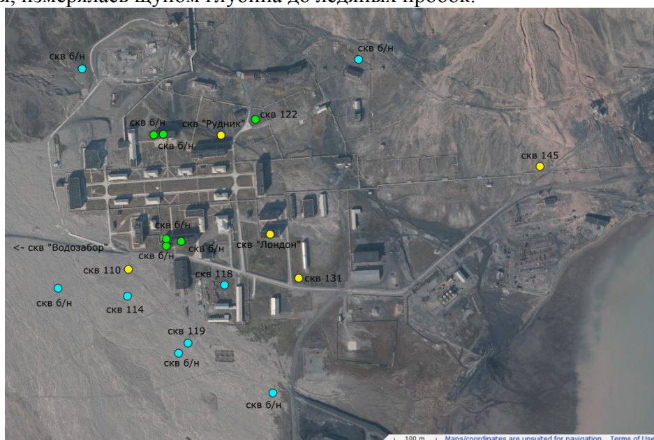
Рисунок 6.1 – Расположение расконсервированных скважин п. Пирамида. Желтый – скважины, оснащенные стационарными термокосами, зеленый – скважины с разовыми замерами температуры, синий – скважины с измерением щупом мощности сезонно-талого слоя
