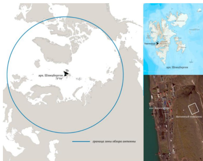
Рисунок 5 – Зоны обзора и расположение автономного пункта приема-передачи спутниковой информации на архипелаге Шпицберген
