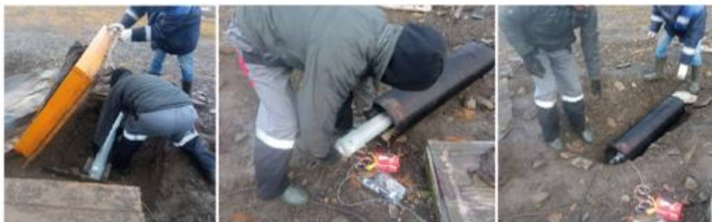
Рисунок 18.15 – Установка датчика в калибровочный соленоид
