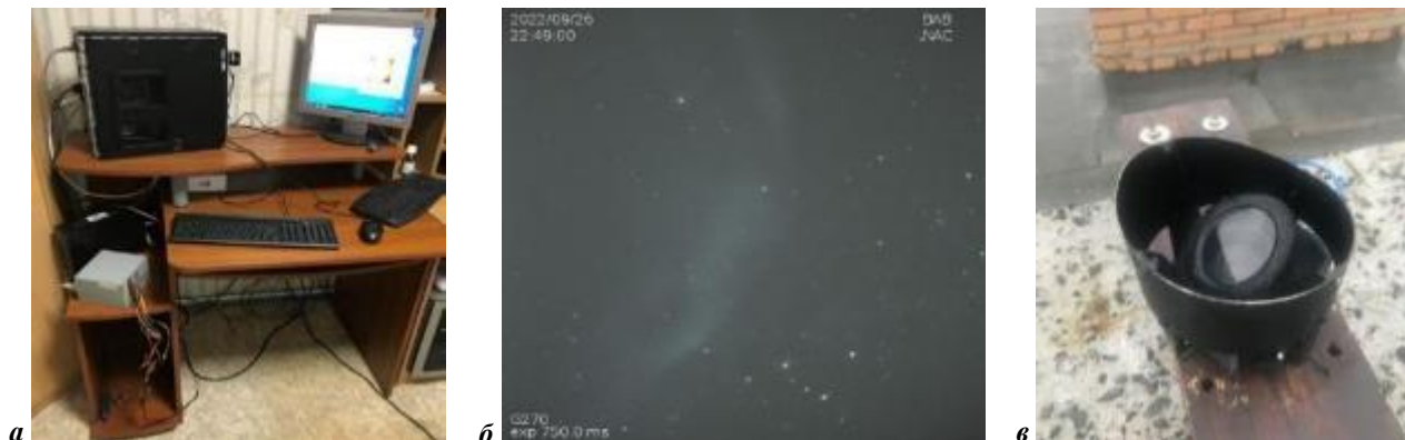
Рисунок 18.9 – (а) система сбора КУ, (б) кадр КУ, (в) общий вид КУ
