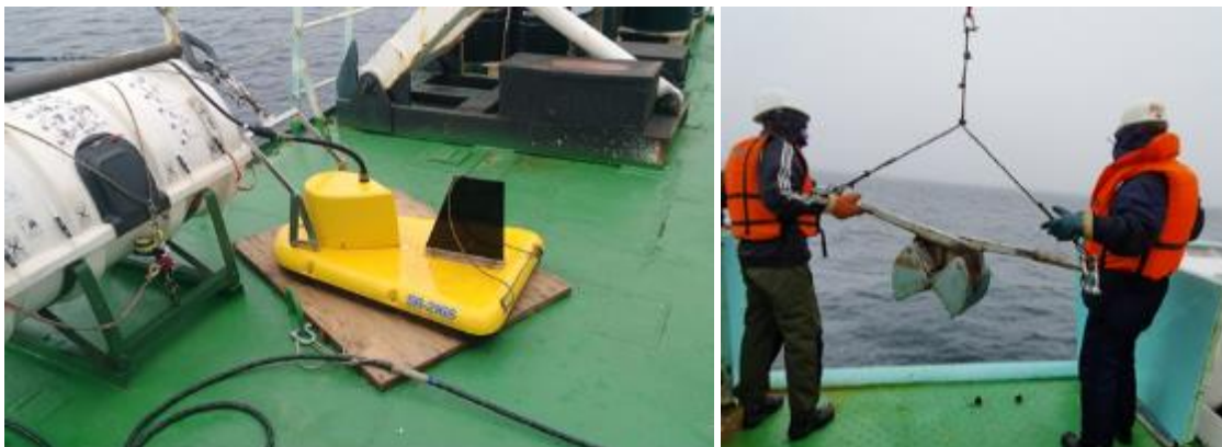
Рисунок 13.3 – Буксируемый аппарат SB-216S EdgeTech (слева) и работа с ковшом Van Vin Grab (справа)
