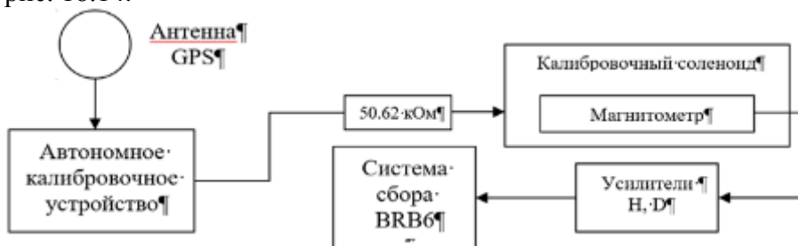
Рисунок 18.14 – Схема проведения калибровки стационарного КНЧ приемника BRB6
