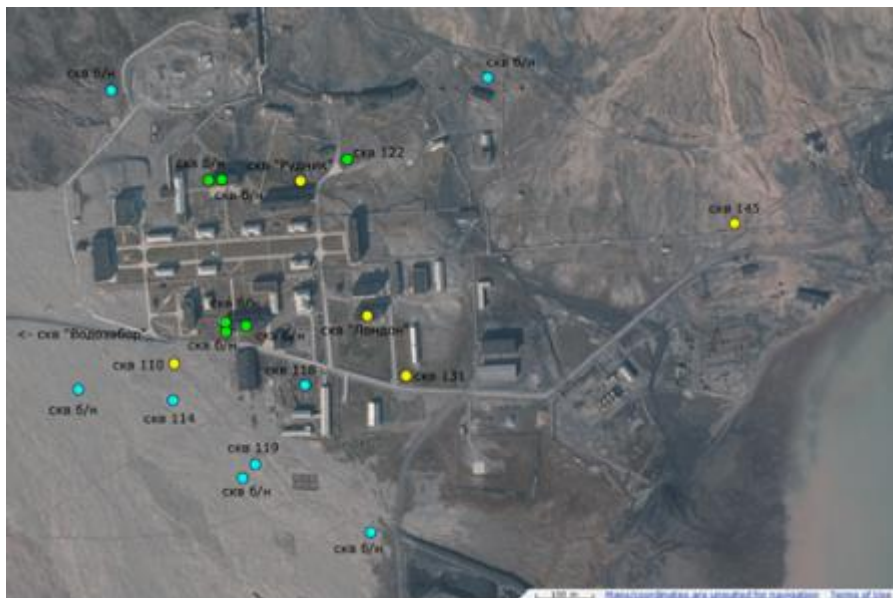
Рисунок 6.2 – Расположение расконсервированных скважин пос. Пирамида. Желтый –скважины, оснащенные стационарными термокосами, зеленый – скважины с разовыми замерами температуры, синий – скважины с измерением мощности СТС щупом
