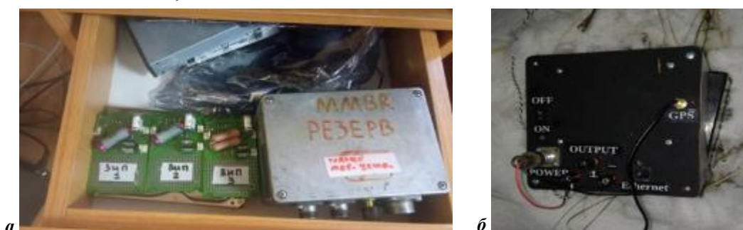
Рисунок 18.12 – (а) Резервный комплект предусилителей; (б) Автономное калибровочное устройство
