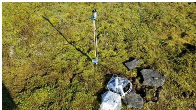
Рисунок 16.3 – Измерительный комплекс для оценки термического режима сезонно-талого слоя
