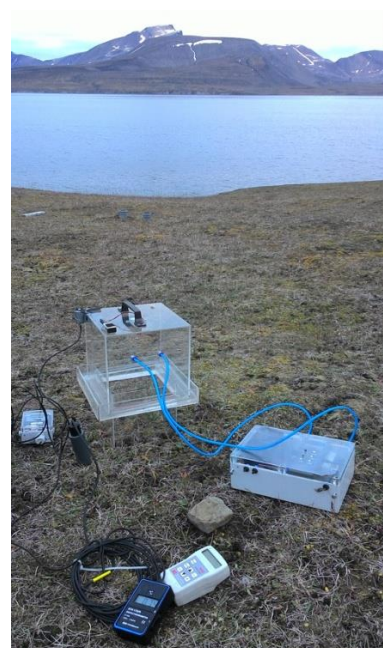
Рисунок 16.7 – Измерение нетто-потоков \text{CO}_2 с помощью установки на основе анализатора AZ 77535 и прозрачной для ФАР камеры. Рядом с камерой – датчики влажности и температуры почвы, и ФАР сенсор с даталоггером
