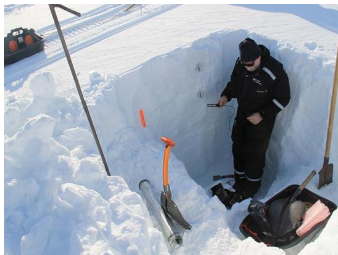
Рисунок 15.2 – Радиолокационная съемка и синхронные измерения характеристик снежного покрова на леднике Восточный Грэнфьорд (толщина, плотность, температура, диэлектрическая проницаемость)
