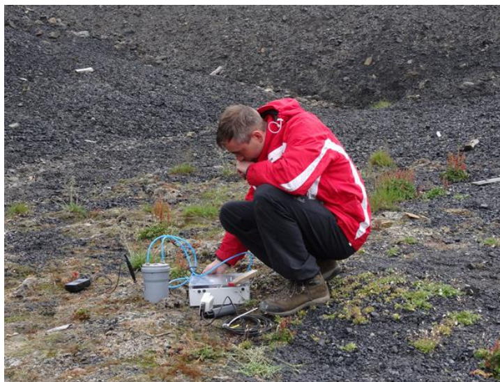
Рисунок 9 – Измерение эмиссии углерода из почвы на зарастающем угольном отвале
