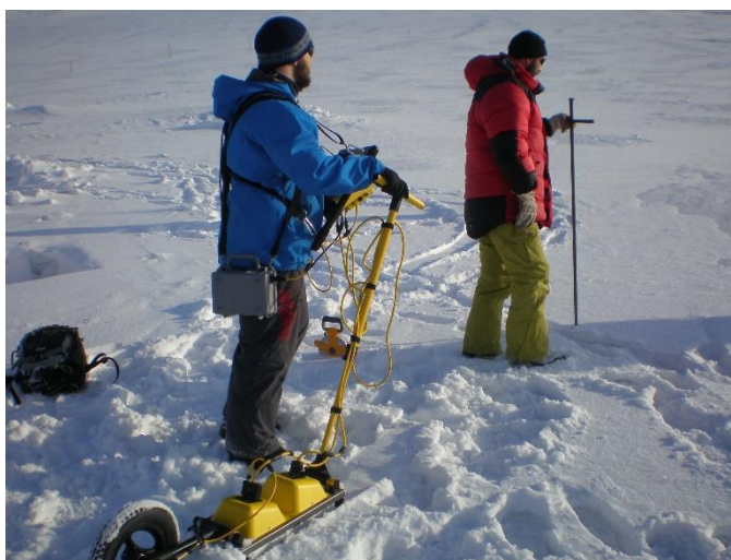
Рисунок 8 – Выполнение измерений толщины снежного покрова 500 МГц георадаром Pulse Ekko и снегомерным щупом
