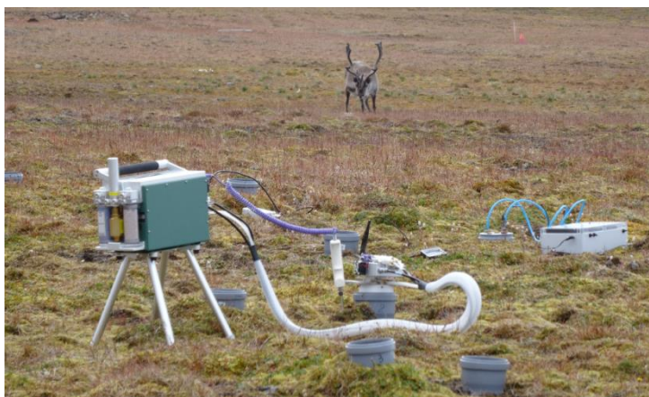
Рисунок 18 – Высокоточный программно-аппаратный комплект для анализа почвенного дыхания и фотосинтеза LI-6400XTF (Li-COR Biosciences UK Ltd.)
