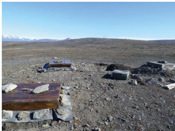
Рисунок 24 – Датчики индукционного магнетометра; а – датчики в коробах; б – коробка, закрытые землей.
